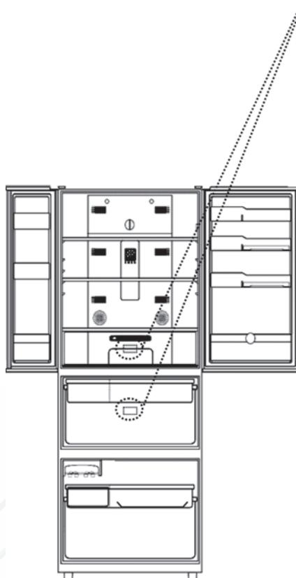
Снимите защитную плёнку с кассет антибактериального фильтра Вассаби в отсеке для овощей и в зоне свежести.
